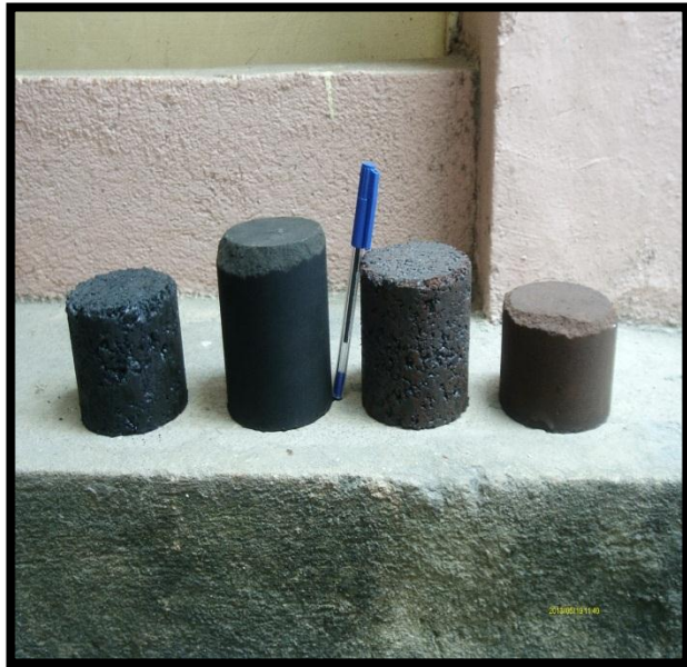
Figure 11: Briques en pouzzolane obtenues après expérimentation (forme cylindrique selon la moule) (Source : Ramanantsoa T., 2017)
