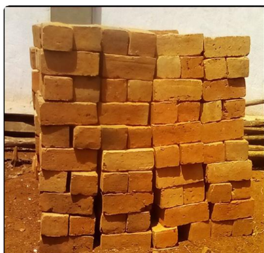
Figure 14 : Briques de terre cuite artisanales 10x10x20
