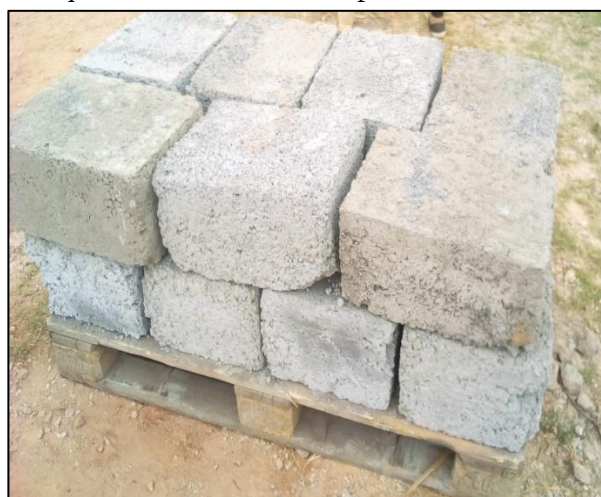
Figure 15 : Briques en pouzzolane 20x20x40
