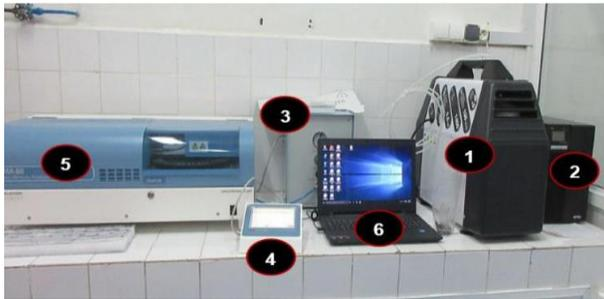
Figure 2 : DMA-80 (Direct Mercury Analyzer) Spectrophotométrie d'absorption atomique (1 : Compresseur ; 2 : Onduleur ; 3 : Filtre ; 4 : Terminal ; 5 : DMA-80, Direct Mercury Analyzer ; 6 : Ordinateur)
