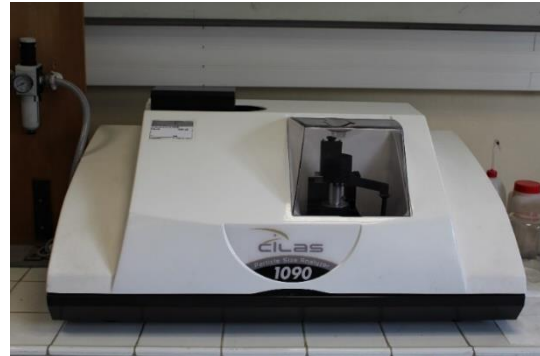
Finesse : Granulomètre laser CILAS 1090 Liquide
