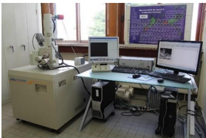
Microscope à Balayage (MEB) Electronique JEOL JSM-6380LV + EDS RONTEC
