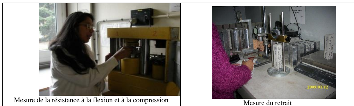
Photo 6 : Mesures de la résistance à la compression et du retrait
