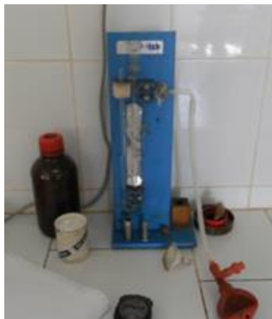
Photo 3 : Appareil Blaine servant à mesurer la surface spécifique Blaine
