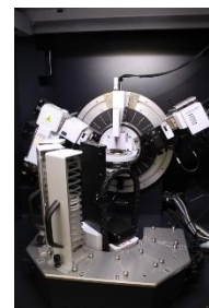
Diffractionmètre à rayons X (DRX) SIEMENS Röntgengenerator KRISTALLOFLEX 710D- avec passeur d'échantillon
