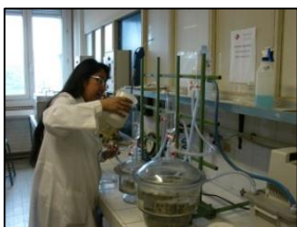
Masse volumique réelle : appareillage à vide
