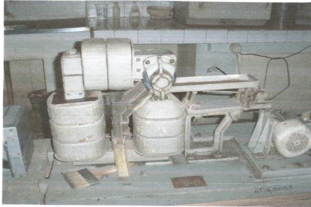
Photos 1 : séparateur magnétique
