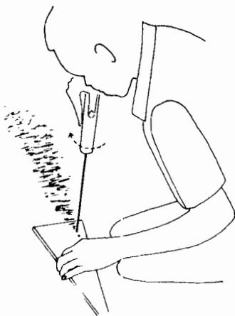
Fig. 11 Autre procédé pour creuser un trou dans un bordé : emploi du sogony, foret chauffé au rouge ( Nosy Mitsio ).
