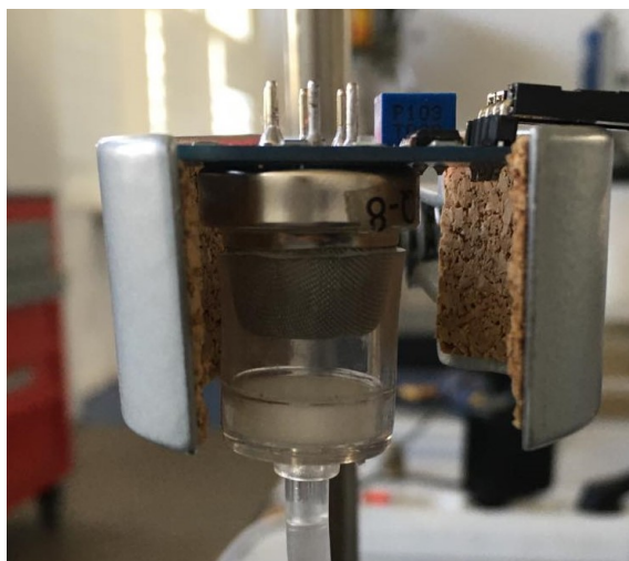
Figure 7 : Positionnement du MQ-8 pour la mesure du H 2 dans la capsule
