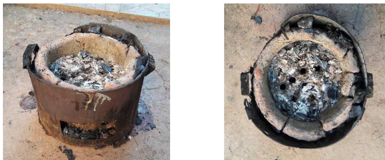
Figure 5 : Foyers améliorés en pleine détérioration
