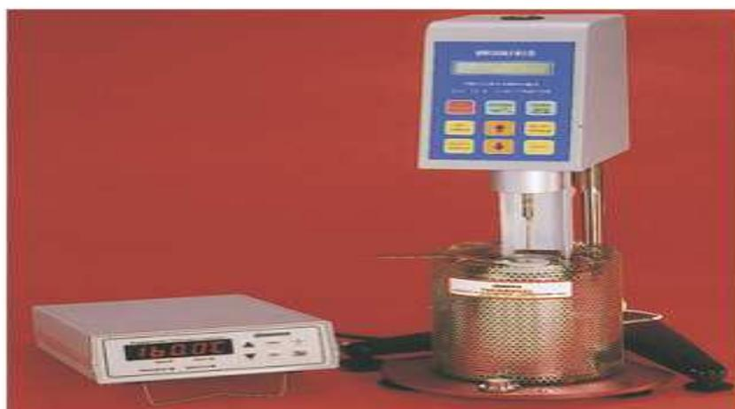
Figure 1: Viscosimètre dynamique BROOKFIELD DV II
