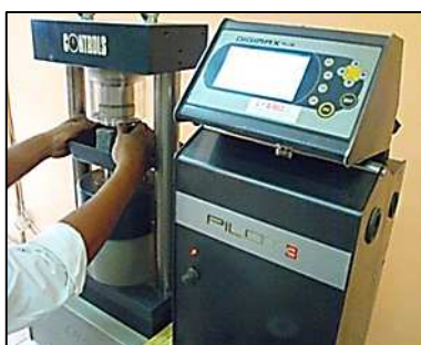
(Figure 19) : Mesure de la résistance à la compression
