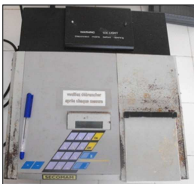
Figure 8 : Mesure de la teneur en sulfate à l'aide d'un spectrophotomètre
