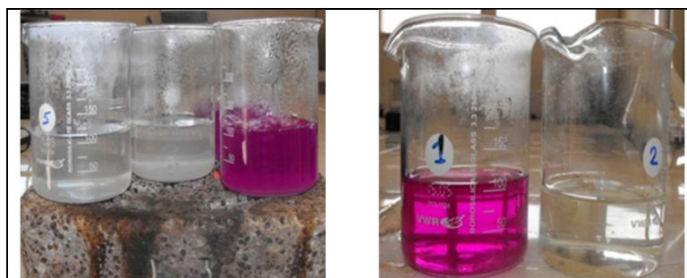
Figure 12 : Ebullition des solutions et virage de coloration lors de la mesure du dosage en M.O.
