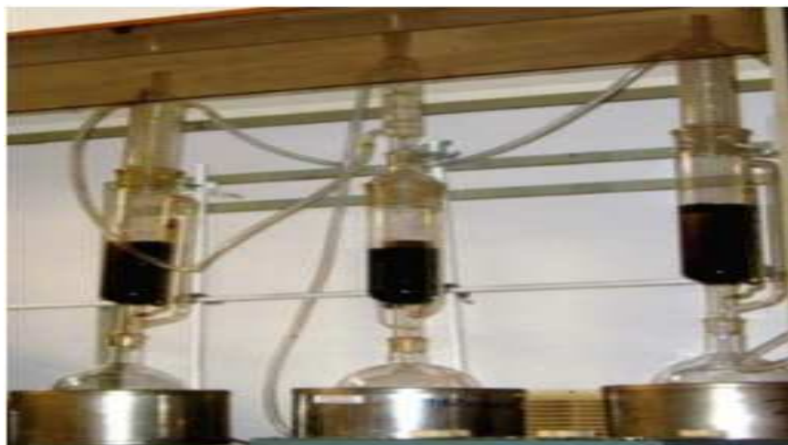
Figure 3 : Dispositif d'extraction d'huile lourde de l'OMNIS
