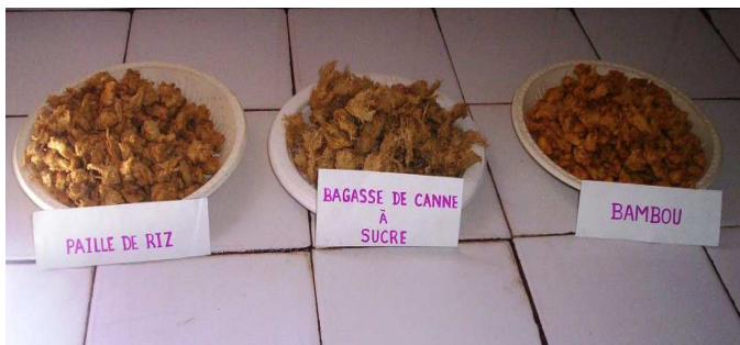
Figure 02: Fibres cellulosiques après séchage à l'étuve 105°C
