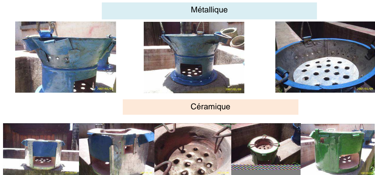
Figure 15 : Configuration de nouveaux foyers adaptés aux briquettes de charbon de terre
