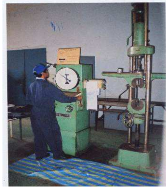
Figure 3 : La presse utilisée pour la mesure de la résistance à la compression
