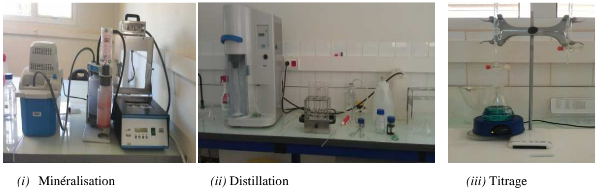
Figure 10- Détermination de l'azote de Kjeldalh
