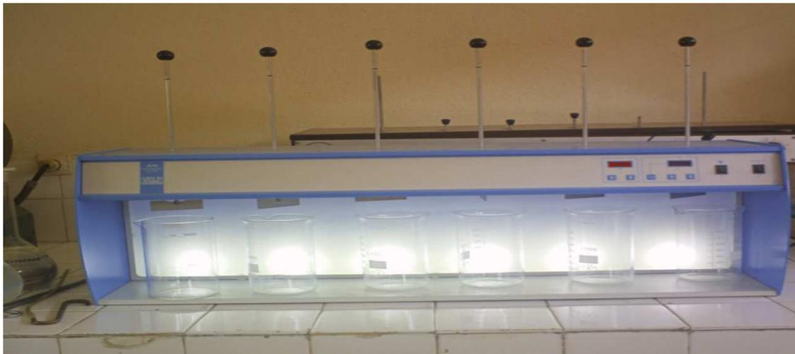
Figure 2 : Photo d'un flocculateur de la JIRAMA
