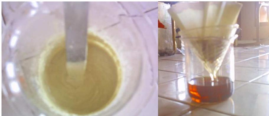
Figure 10: Sulfate ferrique avant la solubilisation (à gauche) et après solubilisation et filtration (à droite).
