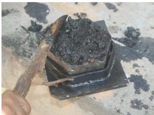
Figure 9 : Moulage du pavé
