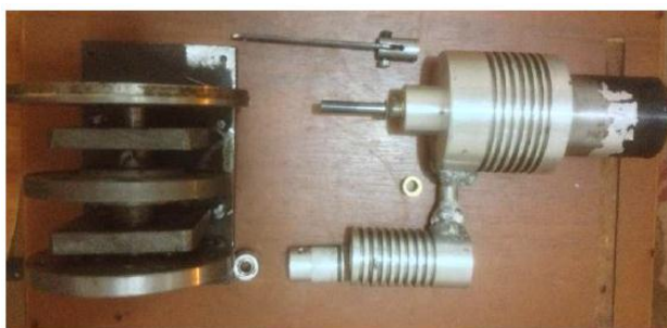
Figure 1 : Pièces assemblées du type Gamma
