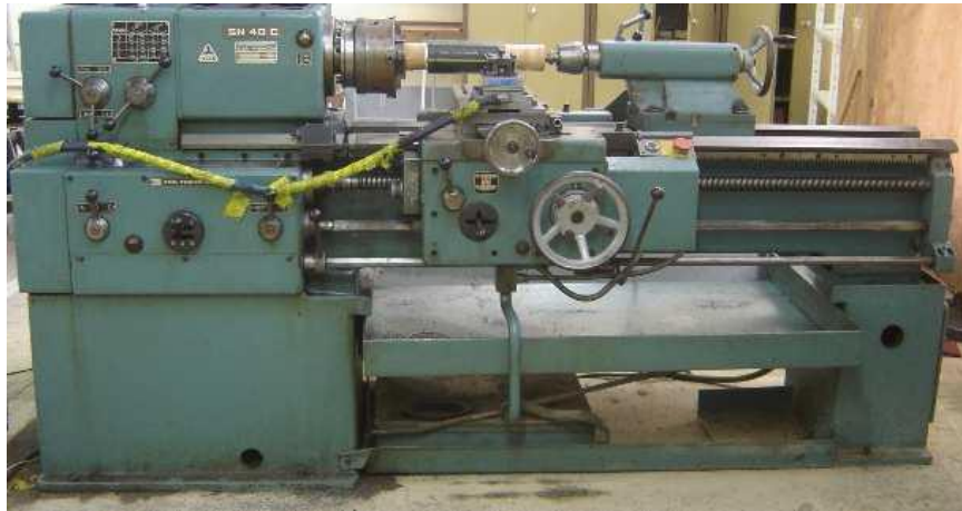
Figure 2 : Tour à charioter et fileter
