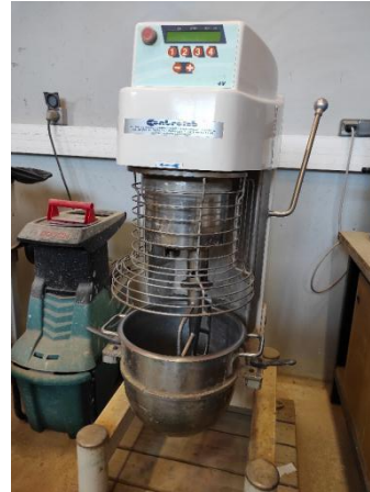
Figure 2 Malaxeur normalisé d'un volume de 7L utilisé pour la confection du mortier et de la pâte de ciment
