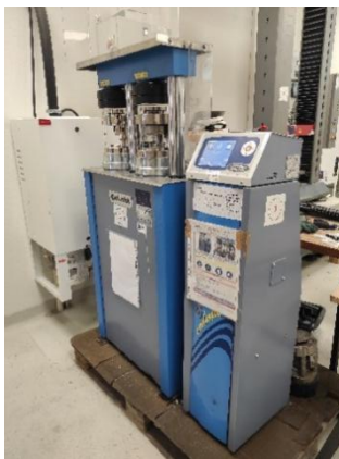
Figure 3 Banc expérimental pour les essais de flexion et de compression sur les prismes 4x4x16
