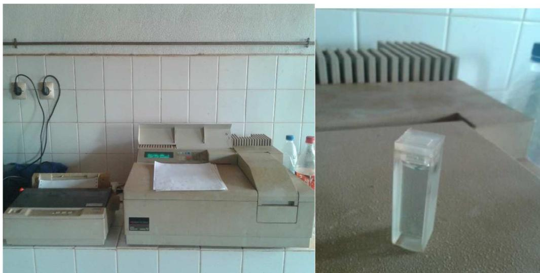
Figure 6 : Spectromètre UV LX-300 et son éprouvette (de gauche à droite)
