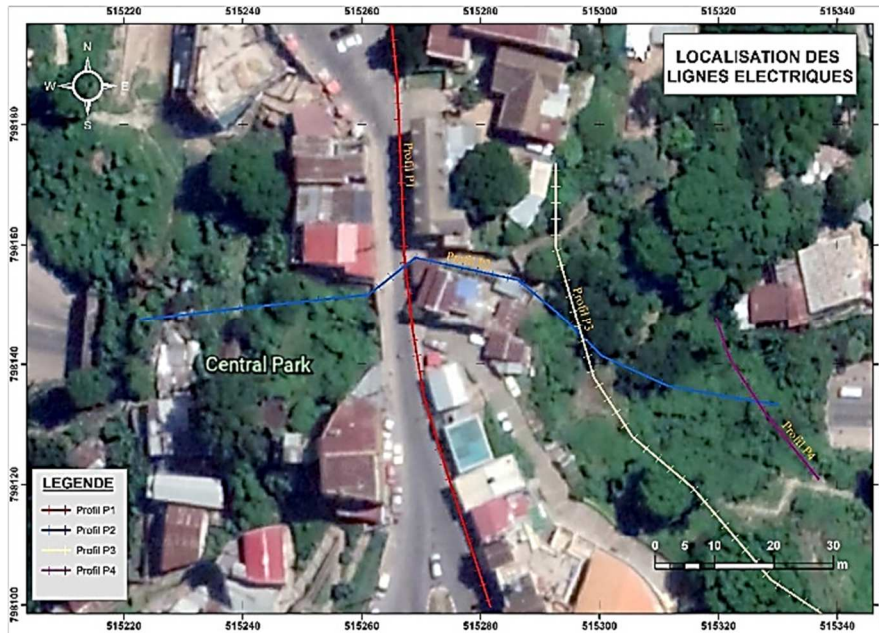
Figure 3. Emplacement géographique des lignes électriques
