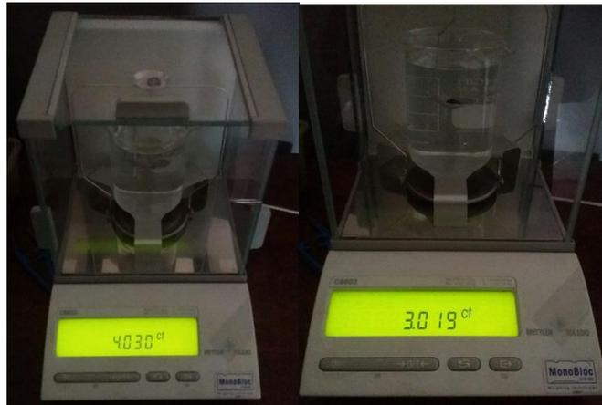
**Figure 21-** Prise de poids dans l'air et dans l'eau de l'échantillon
