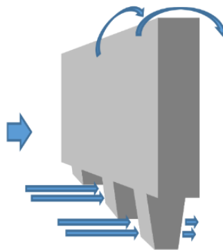
Fig.3 : Effet de passage sous immeuble, pilotis.
