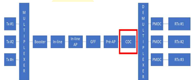
Figure 4 : Schéma bloc d'une liaison optique dans un réseau 5G
