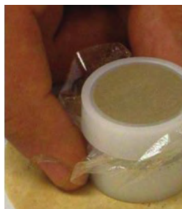
Figure 1: Exemple de coupelle d'échantillon typique contenant de poudre de roche recouverte d'un film de polypropylène de -4 µm d'épaisseur (Simandl, Fajber, et Paradis 2014).
