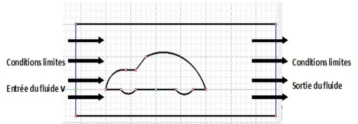
**Figure 11 :** conditions limites impliquées dans le système.
