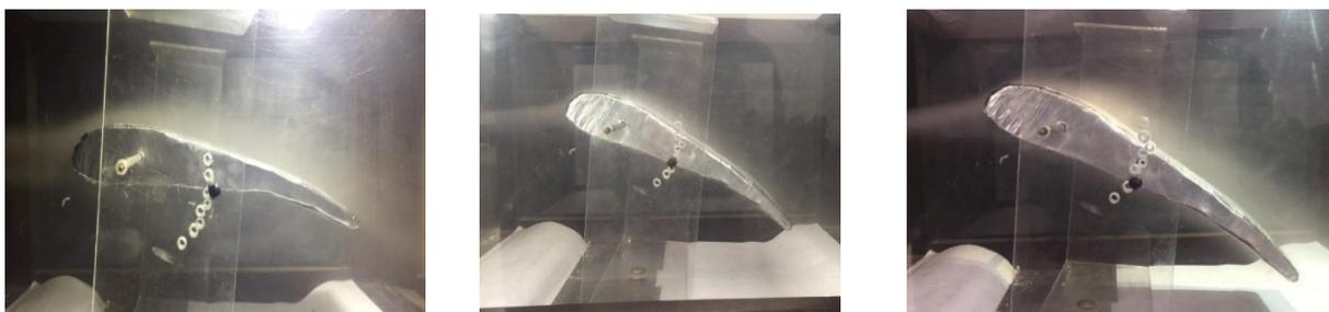
**Figure 8:** Ecoulement autour du profil sans Alula pour  $\alpha = 5^\circ, 10^\circ, 25^\circ$
