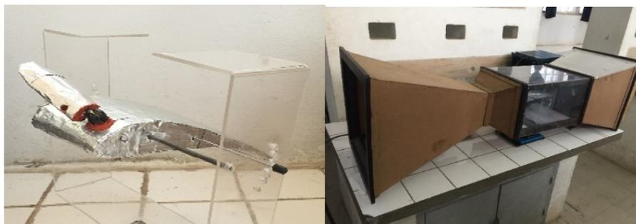
**Figure 4** : Le modèle S1223 avec Alula et la soufflerie
