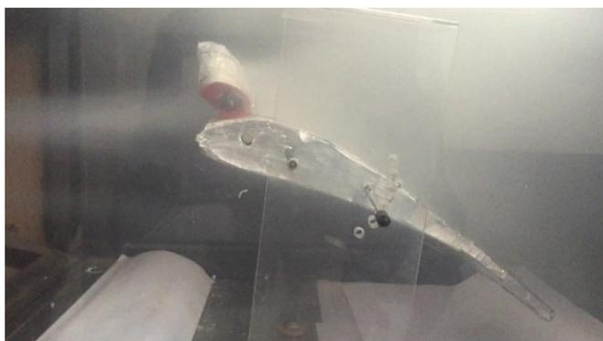
**Figure 9:** Ecoulement autour du profil avec Alula pour  $\alpha = 25^\circ$
