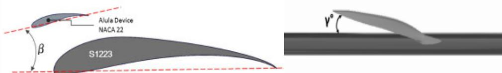
**Figure 5** : Les angles  $\beta$  et  $\gamma$  caractéristiques de l'Alula
