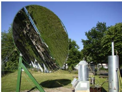
Figure 3 : Distillation des plantes médicinales et aromatiques avec un concentrateur de Scheffler
