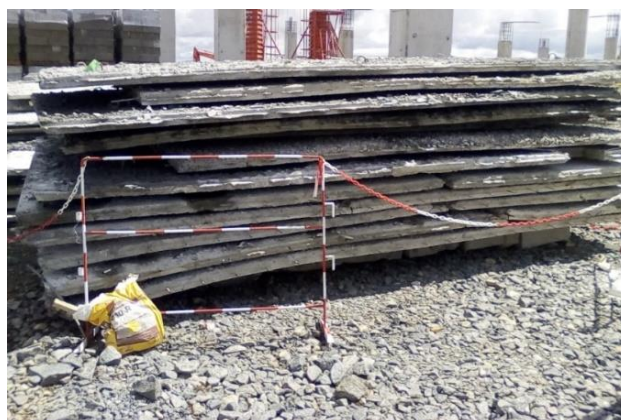
Photo 1 : Mélange liquide et mal proportionné Photo 2 : Béton cassé
