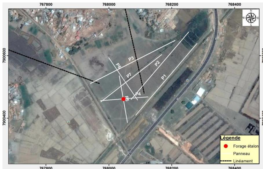
Figure 5 - Implantation des travaux géophysiques
