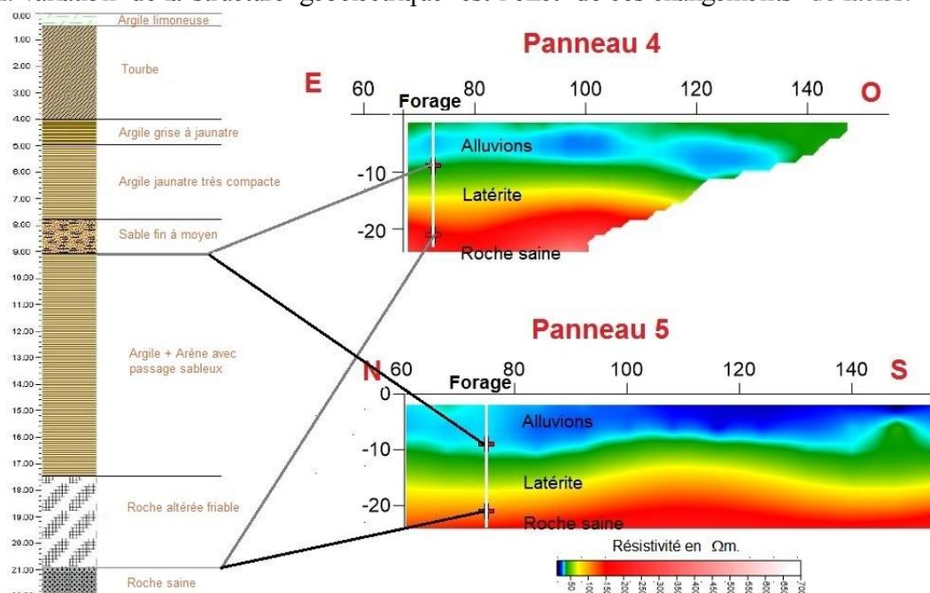
Figure 6 - Etalonnage log de forage - coupe géoélectrique
