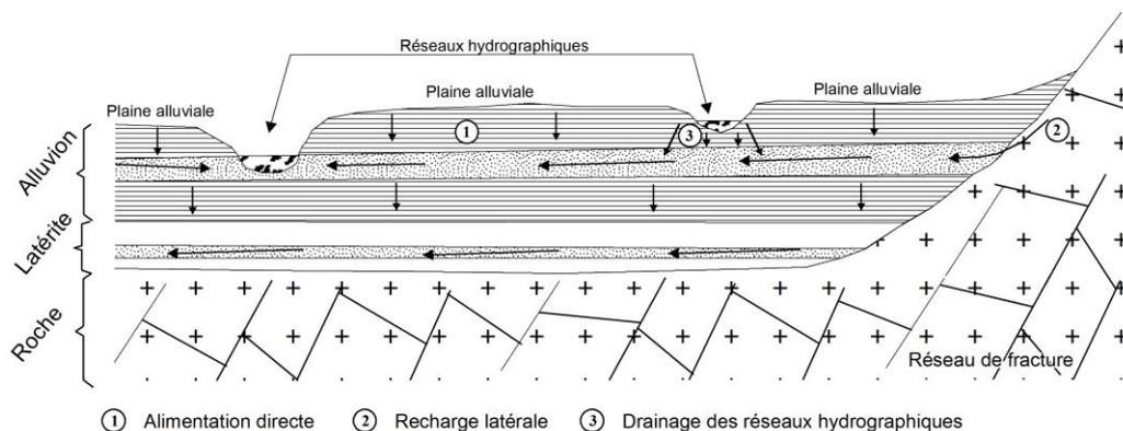
Figure 4- Modèle conceptuel des écoulements souterrains (Dussarat et al. 1992)
