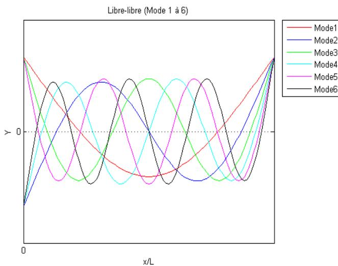
Figure 11 : Déformée modale d'une poutre libre aux extrémités
