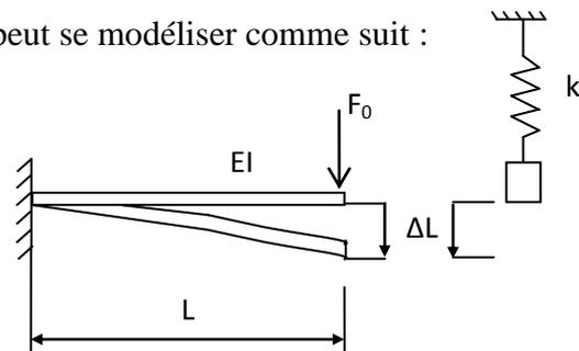
Figure 4 : Modèle de flexion de la poutre encastrée
