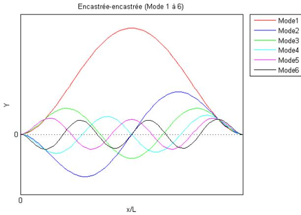
Figure 9 : Déformée modale d'une poutre encastrée aux extrémités
