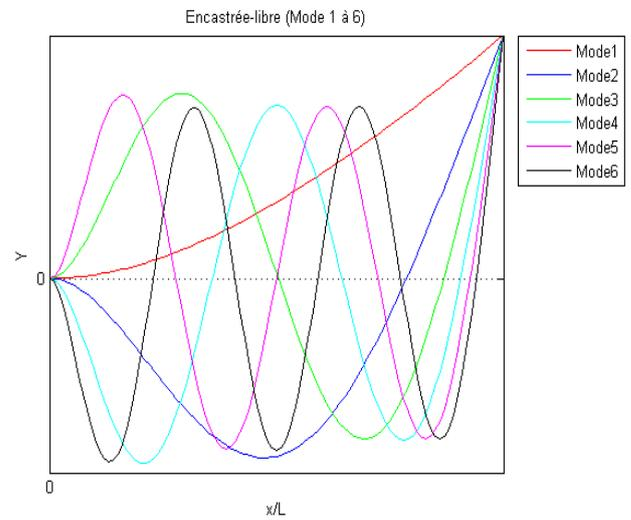
Figure 7 : Déformée modale d'une poutre encastée-libre
