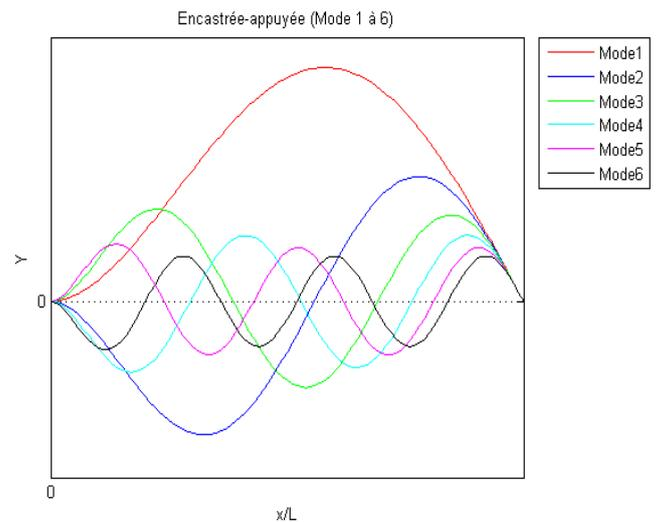
Figure 8 : Déformée modale d'une poutre encastée-appuyée
