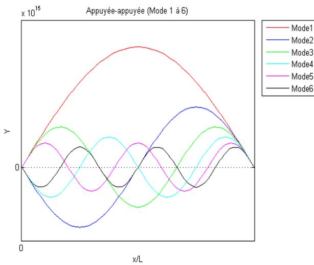
Figure 10 : Déformée modale d'une poutre appuyée aux extrémités
