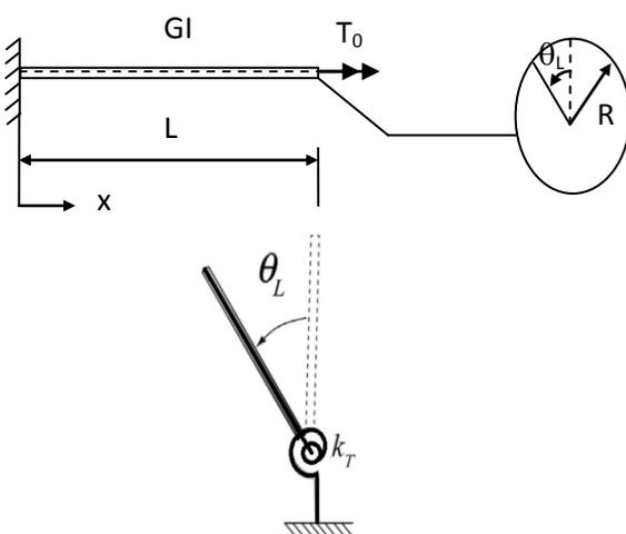
Figure 5 : Modèle de torsion d'une poutre élastique
