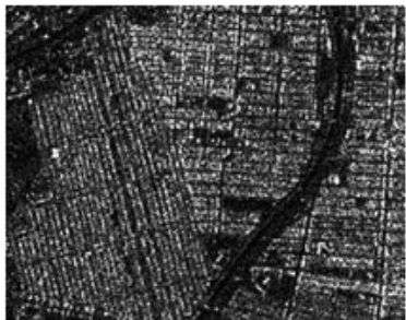
Image RADARSAT-1 F4 DESCENDANTE après compensation radiométrique L'algorithme de compensation radiométrique a rehaussé les pixels correspondant au bâti
